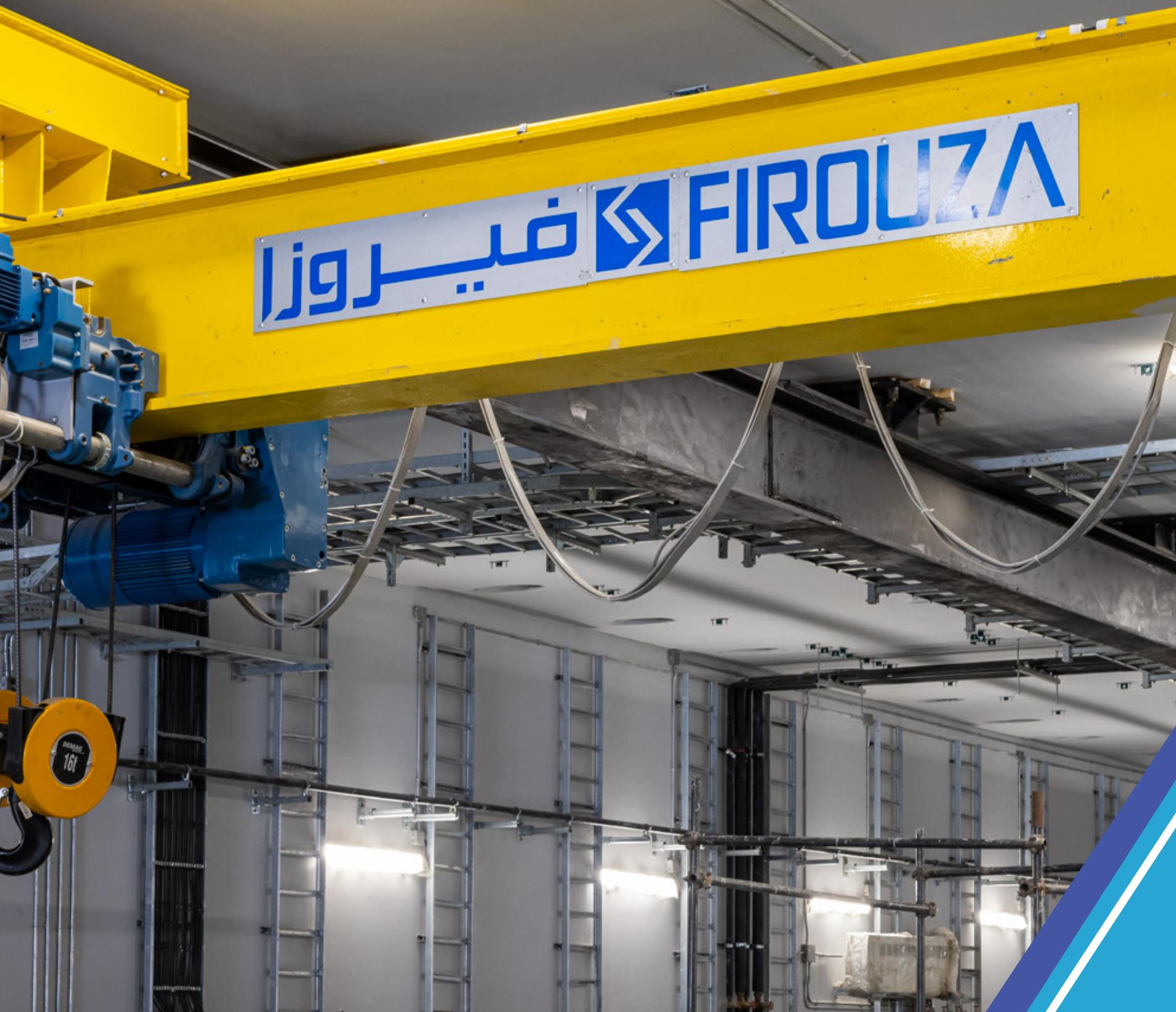
جرثقیل های سقفی تک پل نوعی از جرثقیل سقفی است که از دو کلگی و یک پل متصل بین آنها تشکیل شده است این نوع جرثقیل همراه با سیستم های بالابر معمولی آویز از ظرفیت های ۱ الی ۲۵ تن در طیف گسترده ای از برنامه های کاربردی، با قابلیت بهره وری بالادر تمامی سالن ها (سقف کوتاه یا ارتفاع بلند) منطبق با نیازها و با توجه به شرایط ویژه هر سیستم برای صنایع سبک و سنگین طراحی و تولید می شوند.
